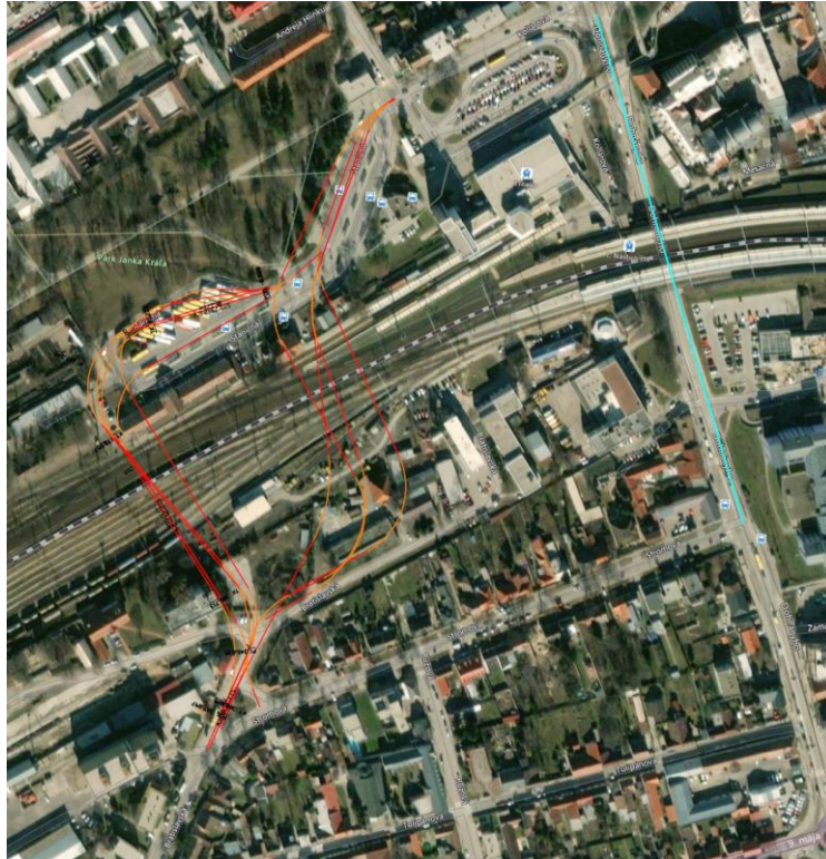
Obr. 3.3.1 Preverované alternatívy vedenia mosta, zdroj : ŽSR
