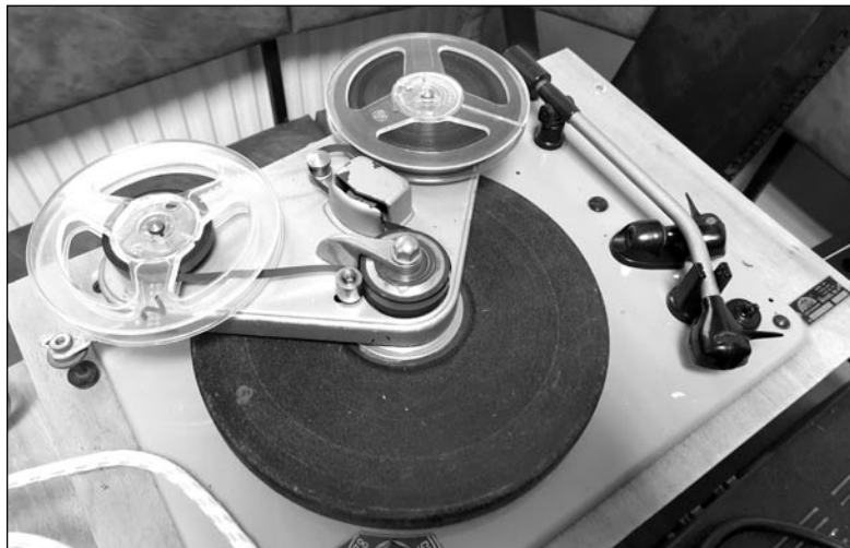
Adaptor nebol samostatný magnetofón, ale adaptér, ktorý sa dával na tanier gramofónu, a ten zabezpečoval jeho pohon.
