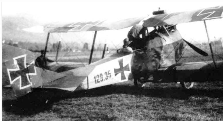
František Wognar dosiahol všetky víťazstvá ako pilot dvojplôšnikov Hansa-Brandenburg C.I. Na zábere vidíme stroj série 129, ktorý vyrobili vo vienskome závode Phönix Flugzeugwerke.
